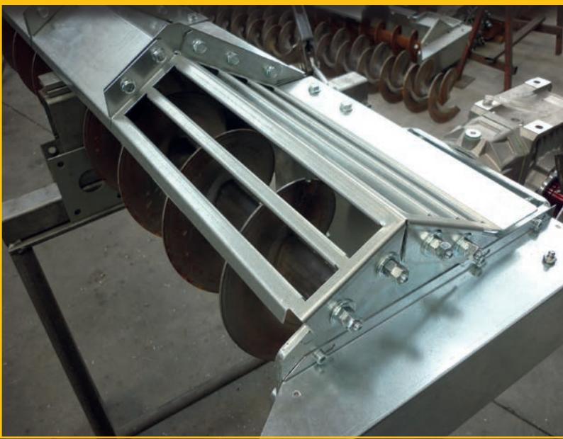
**Gli estrattori rotativi serie BA** vengono impiegati per lo svuotamento del cono residuo all'interno dei silos a fondo piano quando, al termine dello svuotamento centrale, per gravità o meccanico resta all'interno del silos il cono residuo che non è possibile scaricare.
